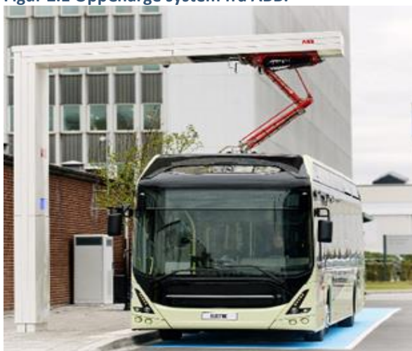
Figur 2.1 OppCharge system fra ABB.
